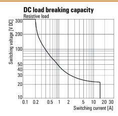
Curva limite di carico DC Carico ohmico
