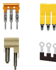
La distribuzione o la moltiplicazione di un potenziale alle morsettiera adiacenti è realizzata tramite una connessione incrociata. Un ulteriore sforzo di cablaggio può essere facilmente evitato. Anche se i poli sono interrotti, l'affidabilità dei contatti nelle morsettiera è garantita. Il nostro portafoglio offre sistemi di connessione incrociata inseribili e avvitabili per morsettiera modulare.
