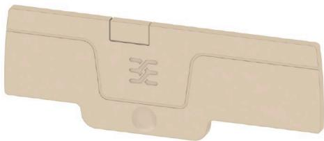
Le piastre terminali sono fissate sul lato aperto dell'ultimo morsetto componibile prima del terminale di fissaggio. Inserendo la piastra terminale viene mantenuta la funzione del morsetto così come la tensione di dimensionamento indicata. È garantita una protezione contro parti sotto tensione e il morsetto terminale è sicuro per le dita.
