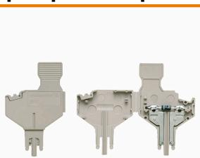
La spina per componenti viene utilizzata per integrare un componente elettronico in una morsettiera di sezionamento. Dopo aver saldato il componente elettronico, la spina può essere integrata nell'area di disconnessione dei nostri morsetti sezionatori e quindi cambia il morsetto sezionatore in un morsetto modulare con componente elettronico integrato.
