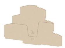
Le piastre terminali sono fissate sul lato aperto dell'ultimo morsetto componibile prima del terminale di fissaggio. Inserendo la piastra terminale viene mantenuta la funzione del morsetto così come la tensione di dimensionamento indicata. È garantita una protezione contro parti sotto tensione e il morsetto terminale è sicuro per le dita.
