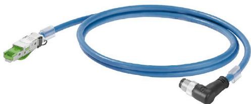
Cavi IE assemblati, cavo per installazioni ferroviarie, cat. 5, PUR, blu, perno diritto M12 e spina di collegamento RJ45, nessu utensile richiesto, IP10
