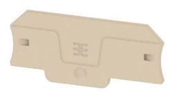
Le piastre terminali sono fissate sul lato aperto dell'ultimo morsetto componibile prima del terminale di fissaggio. Inserendo la piastra terminale viene mantenuta la funzione del morsetto così come la tensione di dimensionamento indicata. È garantita una protezione contro parti sotto tensione e il morsetto terminale è sicuro per le dita.
