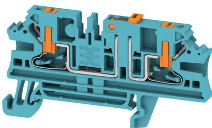
In alcune applicazioni è opportuno aggiungere un rilevatore di prova o un elemento di separazione al morsetto componibile passante per scopi di prova e sicurezza. Con i morsetti per sezionatori di prova potete misurare i circuiti elettrici in assenza di tensione. Sebbene la distanza dei punti di disconnessione e la distanza superficiale non siano valutate in termini dimensionali, deve essere dimostrata la forza di tensione impulsiva di dimensionamento specificata.
