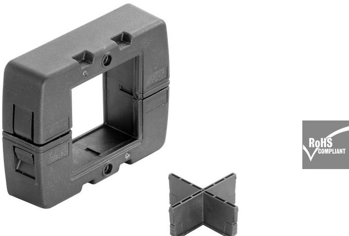
Il telaio, realizzato a partire da un singolo pezzo, è rapido e facile da equipaggiare ed è fatto in plastica rinforzata in fibra di vetro, che assicura stabilità dimensionale. La guarnizione prigioniera in schiuma assicura una sigillatura efficace IP66 in conformità alla norma DIN EN 60529, anche su superfici vernicate e ruvide.
