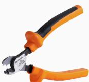
Tagliacavi per conduttori di diametro esterno fino a 8 mm, 12 mm, 14 mm e 22 mm. La speciale geometria della lama consente il taglio netto e pulito di conduttori in rame e alluminio con il minimo sforzo. I tagliacavi (da KT 8 a KT 22) sono disponibili anche con isolamento protettivo verificato VDE e GS per una tensione max. di 1.000 V a norma EN/IEC 60900.
