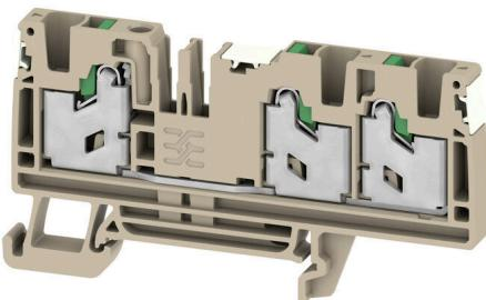
L'alimentazione attraverso l'energia, il segnale e i dati è il classico requisito nell'elettrotecnica e nella realizzazione di quadri elettrici. Il materiale isolante, la tecnica di collegamento e la progettazione dei morsetti componibili sono caratteristiche distintive. Un morsettiera componibile passante è idonea per unire e/o collegare uno o più conduttori. Potrebbero avere uno o più livelli di collegamento che hanno lo stesso potenziale oppure solo isolati l'uno contro l'altro.
