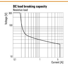
Curva limite di carico DC Carico ohmico
