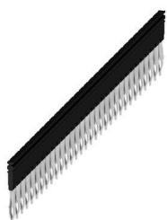
La distribuzione o la moltiplicazione di un potenziale alle morsettiera adiacenti è realizzata tramite una connessione incrociata. Un ulteriore sforzo di cablaggio può essere facilmente evitato. Anche se i poli sono interrotti, l'affidabilità dei contatti nelle morsettiera è garantita. Il nostro portafoglio offre sistemi di connessione incrociata inseribili e avvitabili per morsettiera modulari.
