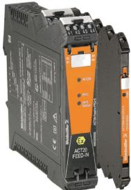
Moduli adattatori di alimentazione per l'alimentazione e la distribuzione separate della tensione per convertitori di segnali della serie ACT20/MICROSERIES. I moduli di alimentazione da 22,5/ 6,1 mm vengono montati accanto ai convertitori di segnali analogici; l'alimentazione a 24 VDC viene ponticellata a richiesta tramite il bus guida CH20M (serie ACT20) oppure semplicemente tramite collegamenti trasversali innestabili ZQV 4N (MICROSERIES).
