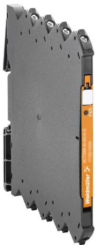
Il trasduttore di misura della frequenza universale configurabile via software isola e converte i segnali di ingresso (frequenza, Namur, NPN, PNP, tacho, TTL e SO) in un segnale di uscita analogico attivo standard. L'alimentazione elettrica è isolata galvanicamente da ingresso e uscita (isolamento a 3 vie) e avviene mediante un cablaggio diretto. Il modello ACT20M-FRQ-AO-S può essere alimentato mediante il bus su guida DIN di Weidmüller
