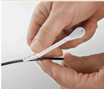
SlimFix è un marcatore per conduttori e cavi dal design poco ingombrante. I marcatori possono essere applicati anche dopo il cablaggio del conduttore. Sono composti in materiale esente da alogeni con classificazione d'infiammabilità V0/V2. SlimFix è un tipo di marcatore collaudato ed apprezzato per le applicazioni nel settore del traffico. Lo strumento SF consente un montaggio facile, anche in presenza di marcatori di piccole dimensioni.
