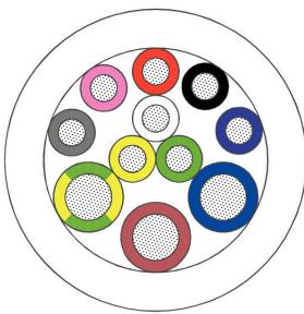
$3 \times 0,75 \text{ mm}^2 + 8 \times 0,34 \text{ mm}^2$
