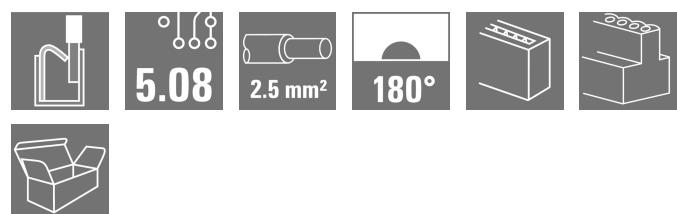
La forte soluzione "Daisy-Chain" per applicazioni di bus di segnali potenti si presta anche per catene di energia ausiliaria da 400V con una corrente di carico max. di 18,5A. Il grande volume di contatto con una sezione del cavo fino a 2,5mm<sup>2</sup>, grazie alla minore caduta di tensione, è particolarmente vantaggioso con cavi bus lunghi o con correnti elevate.
