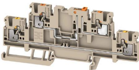
In alcune applicazioni è opportuno aggiungere un rilevatore di prova o un elemento di separazione al morsetto componibile passante per scopi di prova e sicurezza. Con i morsetti per sezionatori di prova potete misurare i circuiti elettrici in assenza di tensione. Sebbene la distanza dei punti di disconnessione e la distanza superficiale non siano valutate in termini dimensionali, deve essere dimostrata la forza di tensione impulsiva di dimensionamento specificata.
