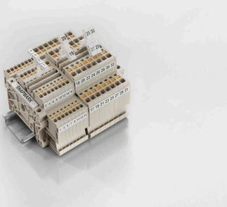
SnapMark - questo portacartellini è stato sviluppato appositamente per i morsetti IDK 1.5N a due piani Serie I. Grazie al flessibile meccanismo orientabile, i collegamenti trasversali possono essere montati o rimossi agevolmente. Può contenere quattro marcatori DEK 5 o due marcatori per siglatura di connettori WS 10/5 Middle.
