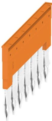
La distribuzione o la moltiplicazione di un potenziale alle morsettiera adiacenti è realizzata tramite una connessione incrociata. Un ulteriore sforzo di cablaggio può essere facilmente evitato. Anche se i poli sono interrotti, l'affidabilità dei contatti nelle morsettiera è garantita. Il nostro portafoglio offre sistemi di connessione incrociata inseribili e avvitabili per morsettiera modulari.
