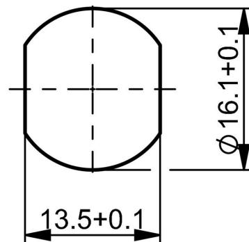
A foro passante con protezione anti torsione
