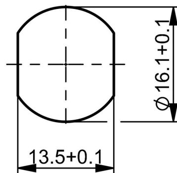
A foro passante con protezione anti torsione
