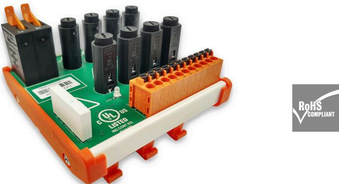
Modulo di distribuzione con 1 potenziale di tensione (1+,2+) in 8 canali protetti da fusibili per collegamento PUSH IN.
