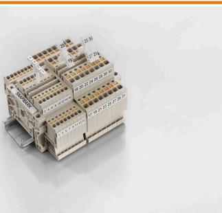
SnapMark - questo portacartellini è stato sviluppato appositamente per i morsetti IDK 1.5N a due piani Serie I. Grazie al flessibile meccanismo orientabile, i collegamenti trasversali possono essere montati o rimossi agevolmente. Può contenere quattro marcatori DEK 5 o due marcatori per siglatura di connettori WS 10/5 Middle.
