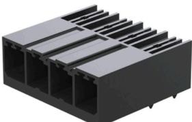
Connettori maschio ad alte prestazioni per correnti forti su una fila, affiancabili senza perdita di poli o con flangia per un rapido fissaggio senza utensili. Massima affidabilità di collegamento e funzionamento grazie ad un controprofilo che impedisce errori di collegamento, con diversità di codifica univoca e fissaggio supplementare nella flangia.
