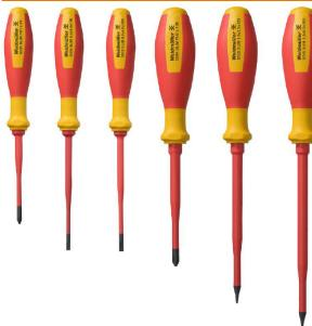
Cacciaviti isolati VDE per lavori su parti sotto tensione fino a AC 1000 V e DC 1500 V, DIN EN 60900, IEC 900. Sicurezza testata GS, collaudo su ogni singolo pezzo. Lama in acciaio al cromo-vanadio-molibdeno, temprato, superficie lucidata.
