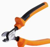
Tagliacavi per conduttori di diametro esterno fino a 8 mm, 12 mm, 14 mm e 22 mm. La speciale geometria della lama consente il taglio netto e pulito di conduttori in rame e alluminio con il minimo sforzo. I tagliacavi (da KT 8 a KT 22) sono disponibili anche con isolamento protettivo verificato VDE e GS per una tensione max. di 1.000 V a norma EN/IEC 60900.
