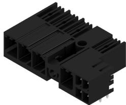
Combinazione con striscia di connettori maschio a 90° con contatti di potenza e segnale, con tecnica di collegamento PUSH IN, compreso dispositivo di blocco della flangia centrale autobloccante e collegamento schermato ad innesto (opzionale) con passo 7,62.
