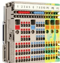
Il concetto modulare unico può essere adattato ad ogni tipo di macchina. I morsetti componibili di distribuzione del potenziale AAP hanno successo grazie alla loro progettazione uniforme con due possibili costruzioni, alternate o raggruppate. Nella struttura a gruppi della distribuzione della tensione di comando, i potenziali si trovano su diversi morsetti e formano così interi blocchi di potenziale.
