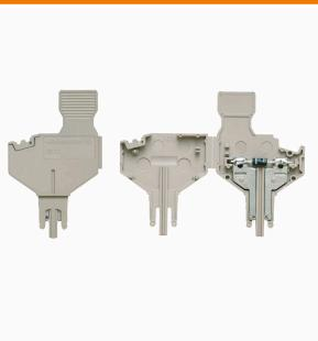
La spina per componenti viene utilizzata per integrare un componente elettronico in una morsettiera di sezionamento. Dopo aver saldato il componente elettronico, la spina può essere integrata nell'area di disconnessione dei nostri morsetti sezionatori e quindi cambia il morsetto sezionatore in un morsetto modulare con componente elettronico integrato.
