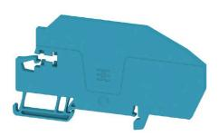
Le piastre terminali sono fissate sul lato aperto dell'ultimo morsetto componibile prima del terminale di fissaggio. Inserendo la piastra terminale viene mantenuta la funzione del morsetto così come la tensione di dimensionamento indicata. È garantita una protezione contro parti sotto tensione e il morsetto terminale è sicuro per le dita.
