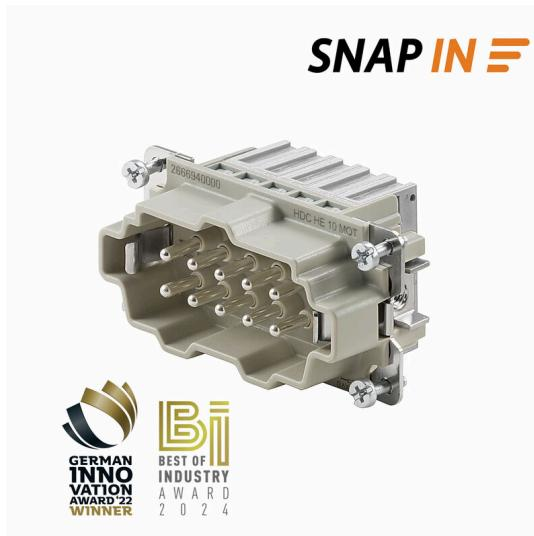
Con la connessione SNAP IN, il livello di collegamento del conduttore è già aperto e il connettore spellato può essere semplicemente inserito. Nella posizione finale, il meccanismo di serraggio brevettato si chiude automaticamente. Pertanto, è praticamente esente da manutenzione e permette la creazione di un collegamento sicuro, permanente e resistente alle vibrazioni. Weidmüller è quindi il primo e unico produttore ad offrire questo sistema di collegamento innovativo.
