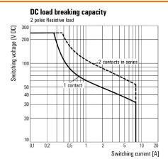
Curva limite di carico DC Carico ohmico
