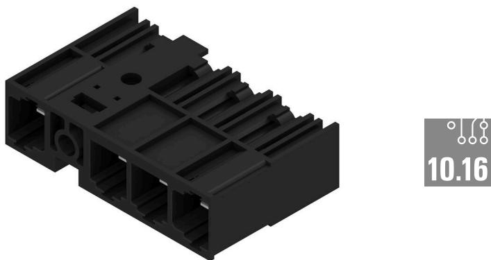
Connettore maschio con fissaggio con flangia a saldare centrale nel passo 10,16 per sistemi di IT da 400 V secondo la norma IEC 61800-5-1.
