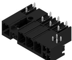
Combinazione con striscia di connettori maschio a 270° con contatti di potenza e segnale, compreso dispositivo di blocco della flangia centrale autobloccante con passo 7,62.
