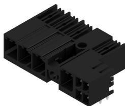
Combinazione con striscia di connettori maschio a 90° con contatti di potenza e segnale, con tecnica di collegamento PUSH IN, compreso dispositivo di blocco della flangia centrale autobloccante e collegamento schermato ad innesto (opzionale) con passo 7,62.
