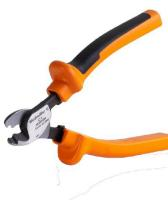
Tagliacavi per conduttori di diametro esterno fino a 8 mm, 12 mm, 14 mm e 22 mm. La speciale geometria della lama consente il taglio netto e pulito di conduttori in rame e alluminio con il minimo sforzo. I tagliacavi (da KT 8 a KT 22) sono disponibili anche con isolamento protettivo verificato VDE e GS per una tensione max. di 1.000 V a norma EN/IEC 60900.
