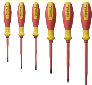
Cacciaviti isolati VDE per lavori su parti sotto tensione fino a AC 1000 V e DC 1500 V, DIN EN 60900, IEC 900. Sicurezza testata GS, collaudo su ogni singolo pezzo. Lama in acciaio al cromo-vanadio-molibdeno, temprato, superficie lucidata.
