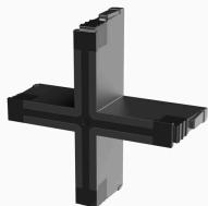
L'inserto innestabile permette di configurare le aperture del telaio come necessario per l'uso con guarnizioni piccole o grandi. Un "click" percettibile conferma la corretta installazione. Questo significa che il sistema di inserimento cavi Cabtite può essere configurato in modo diverso a seconda delle necessità (cavi, conduttori, tubi flessibili, linee pneumatiche e idrauliche).
