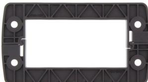
Il telaio, realizzato a partire da un singolo pezzo, è rapido e facile da equipaggiare ed è fatto in plastica rinforzata in fibra di vetro, che assicura stabilità dimensionale. La guarnizione prigioniera in schiuma assicura una sigillatura efficace IP66 in conformità alla norma DIN EN 60529, anche su superfici vernicate e ruvide.
