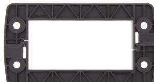
Il telaio, realizzato a partire da un singolo pezzo, è rapido e facile da equipaggiare ed è fatto in plastica rinforzata in fibra di vetro, che assicura stabilità dimensionale. La guarnizione prigioniera in schiuma assicura una sigillatura efficace IP66 in conformità alla norma DIN EN 60529, anche su superfici vernicate e ruvide.
