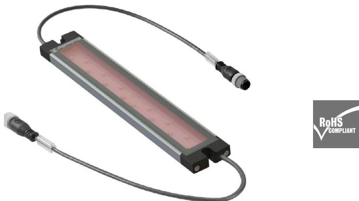
Famiglia di lampadine WIL-LED: lampadine LED, solo 8 mm di altezza (9,4 mm con magnete), 24V DC con resa luminosa molto elevata e lunga durata (oltre 60.000 ore). Costruzione molto robusta, con incapsulamento completo e custodia in metallo - impermeabile (IP67). Grazie alla sua luce rossa è adatta a effetti di colore speciali. Opzionale il collegamento semplice con connettore M12. Grazie alla ridotta potenza assorbita, per il funzionamento è sufficiente un piccolo alimentatore da 24V.
