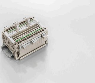
Il portamarcatore offre la possibilità di un ulteriore montaggio di marcatori di standard con un passo di 5 o 5,1 mm. I supporti angolari possono essere combinati optionalmente e montati in tutti i canali di marcatura standard delle morsettiera modulari Klippon®. I tipi di marcatori adatti sono reperibili sotto i rispettivi accessori del supporto per siglatura di designazione.
