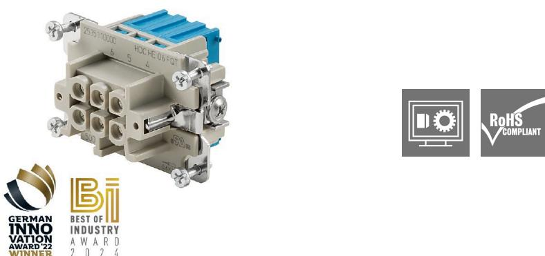
Con la connessione SNAP IN, il livello di collegamento del conduttore è già aperto e il connettore spellato può essere semplicemente inserito. Nella posizione finale, il meccanismo di serraggio brevettato si chiude automaticamente. Pertanto, è praticamente esente da manutenzione e permette la creazione di un collegamento sicuro, permanente e resistente alle vibrazioni. Weidmüller è quindi il primo e unico produttore ad offrire questo sistema di collegamento innovativo.
