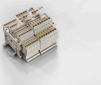
SnapMark - questo portacartellini è stato sviluppato appositamente per i morsetti IDK 1.5N a due piani Serie I. Grazie al flessibile meccanismo orientabile, i collegamenti trasversali possono essere montati o rimossi agevolmente. Può contenere quattro marcatori DEK 5 o due marcatori per siglatura di connettori WS 10/5 Middle.
