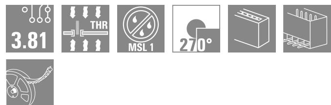
Il connettore maschio SC-SMT resistente alle alte temperature con direzione di uscita a 270° - l'angolo di 270° viene definito tra la direzione di innesto e il pin brasato e distingue la direzione di innesto parallela rispetto al circuito stampato, ma per l'innesto di connettori femmina attraverso la testa.
