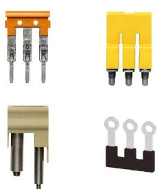
La distribuzione o la moltiplicazione di un potenziale alle morsettiera adiacenti è realizzata tramite una connessione incrociata. Un ulteriore sforzo di cablaggio può essere facilmente evitato. Anche se i poli sono interrotti, l'affidabilità dei contatti nelle morsettiera è garantita. Il nostro portafoglio offre sistemi di connessione incrociata inseribili e avvitabili per morsettiera modulari.
