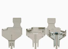
La spina per componenti viene utilizzata per integrare un componente elettronico in una morsettiera di sezionamento. Dopo aver saldato il componente elettronico, la spina può essere integrata nell'area di disconnessione dei nostri morsetti sezionatori e quindi cambia il morsetto sezionatore in un morsetto modulare con componente elettronico integrato.
