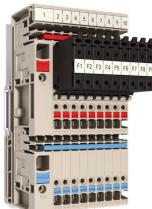
Il concetto modulare unico può essere adattato ad ogni tipo di macchina. I morsetti componibili di distribuzione del potenziale AAP hanno successo grazie alla loro progettazione uniforme con due possibili costruzioni, alternate o raggruppate. Con la progettazione alternativa della distribuzione corrente di comando, entrambi i potenziali si trovano su una sola morsettiera.
