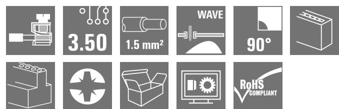
Morsetto per circuito stampato, molto piccolo e compatto, con collegamento con staffa a pressione nel passo 3,5 mm e direzione d'uscita del conduttore a 90°. Adatto per sezioni del cavo fino a 1,5 mm<sup>2</sup>.
