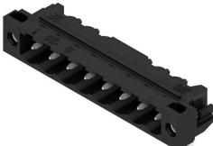
Striscia di connettori maschio resistenti alle alte temperature, in confezione Box o Tape. Su Tape, con codolo a saldare da 1,5 mm, ottimizzati per l'equipaggiamento automatico. Codolo a saldare da 3,2 mm, indicato per saldatura reflow e a onda. Le strisce di connettori maschio presentano uno spazio per la siglatura e sono codificabili. HC = High Current (a corrente forte).
